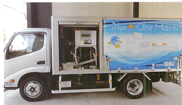
外部への電源供給も可能な「IBC ローリーサービス」の配送車両
